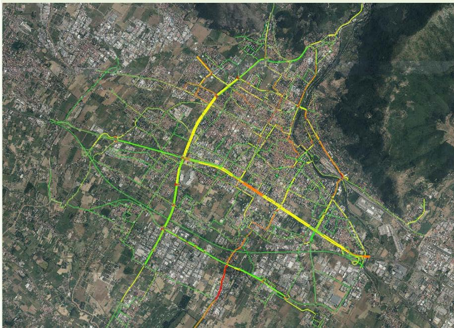
*Esempio di microsimulazione di un asse stradale complesso (grafo)*
