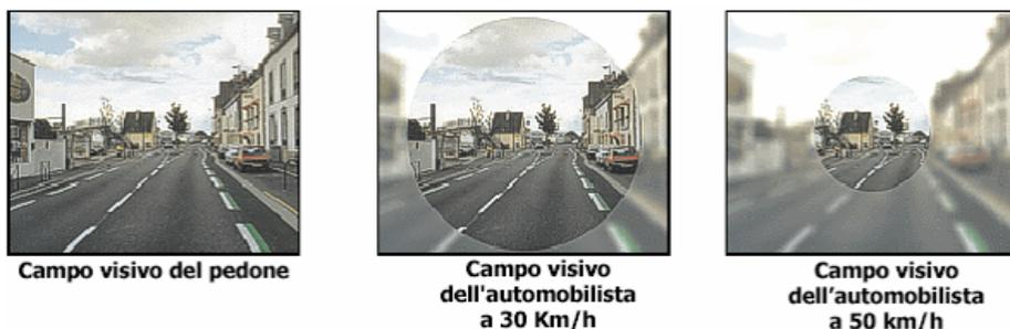
Figura 7-1: Comparazione del campo visivo a differenti velocità
