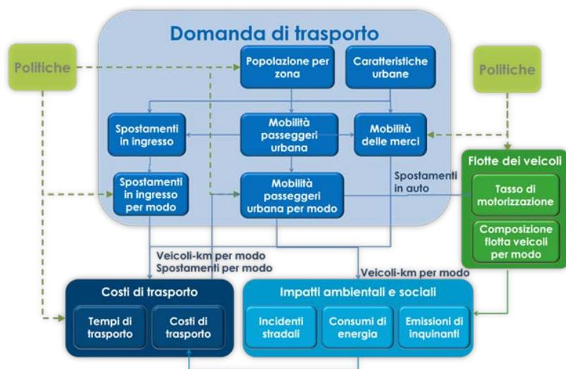
Figura 9-2: Struttura e relazioni tra i moduli di calcolo di MOMOS
