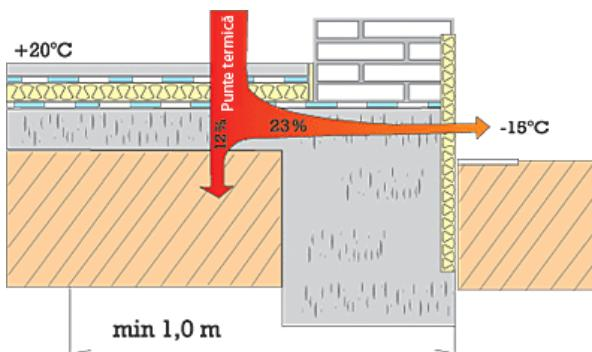
**Planșeu pe sol – instalare corectă**
