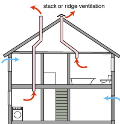
*Stack or ridge ventilation - Ventilație prin țeava de aerisire*
